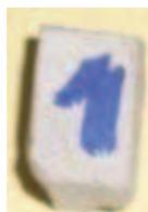
*Figure 4.3 L'échantillon prismatique de (10x10x15) mm<sup>3</sup>*
