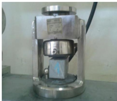
Figure 4.7 Essai de compression sur un échantillon cubique 40x40x40 mm<sup>3</sup>
