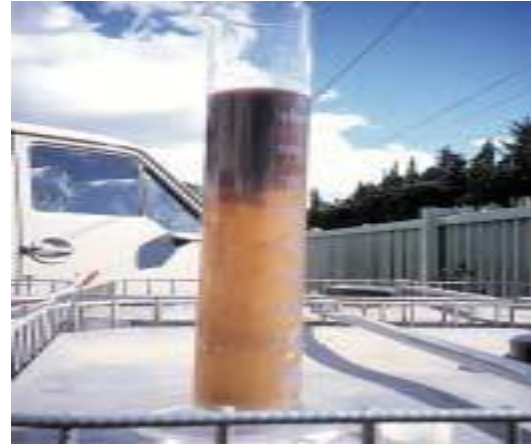
Fig. III.31 : Test en éprouvette : remonté de boue.
