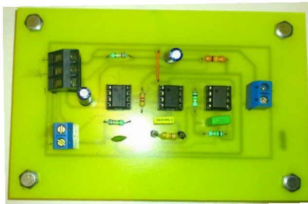
Figure 3.15 : Circuit le filtrage du signal oscillométrique
