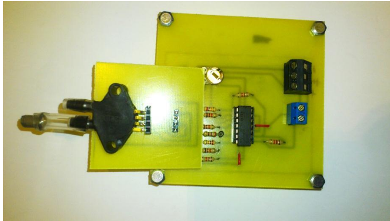
Figure 3.11 : Circuit de mise en forme branché avec le capteur MPX2010DP
