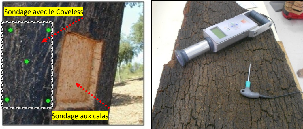
Planche 8: Méthode de mesure de la qualité du liège sur arbre au coveless(Cliché Mr Dehane, 2017)
