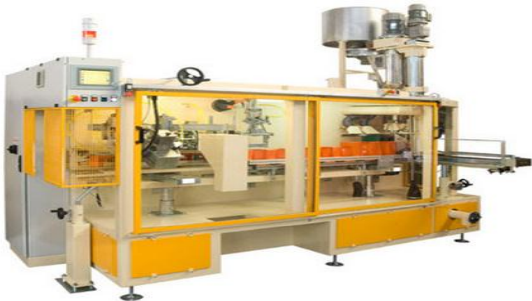
Figure 44 : cartonneuse pour lait en poudre [galerie logismarket]
