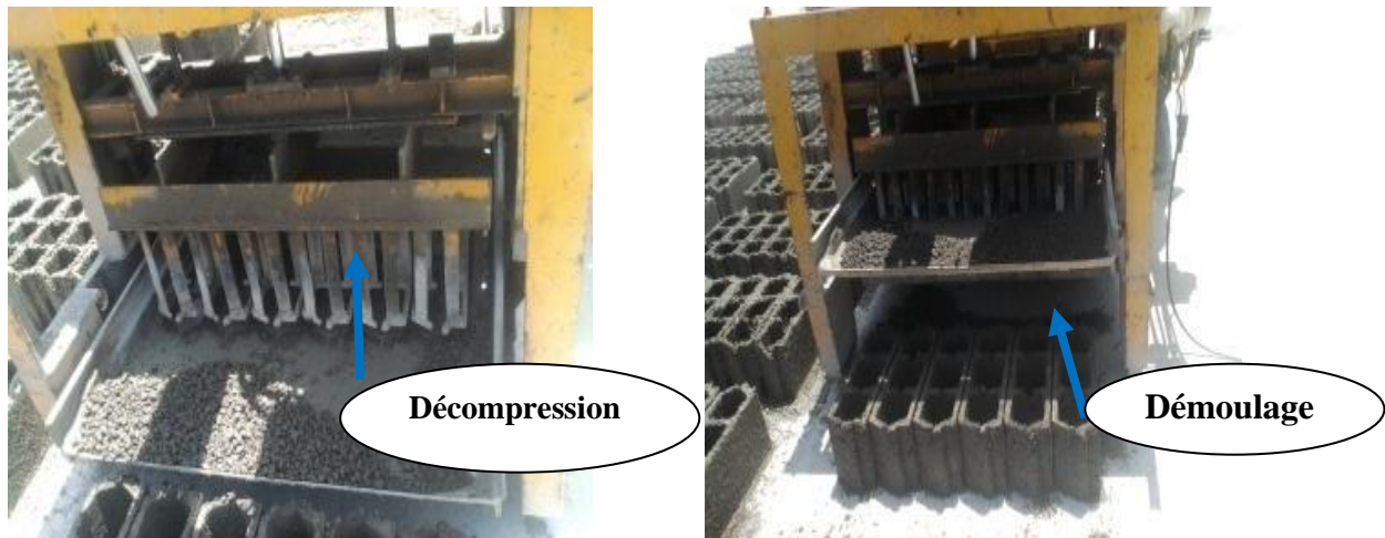
Figure III.7: décompression et démoulage des blocs sur plate-forme.
