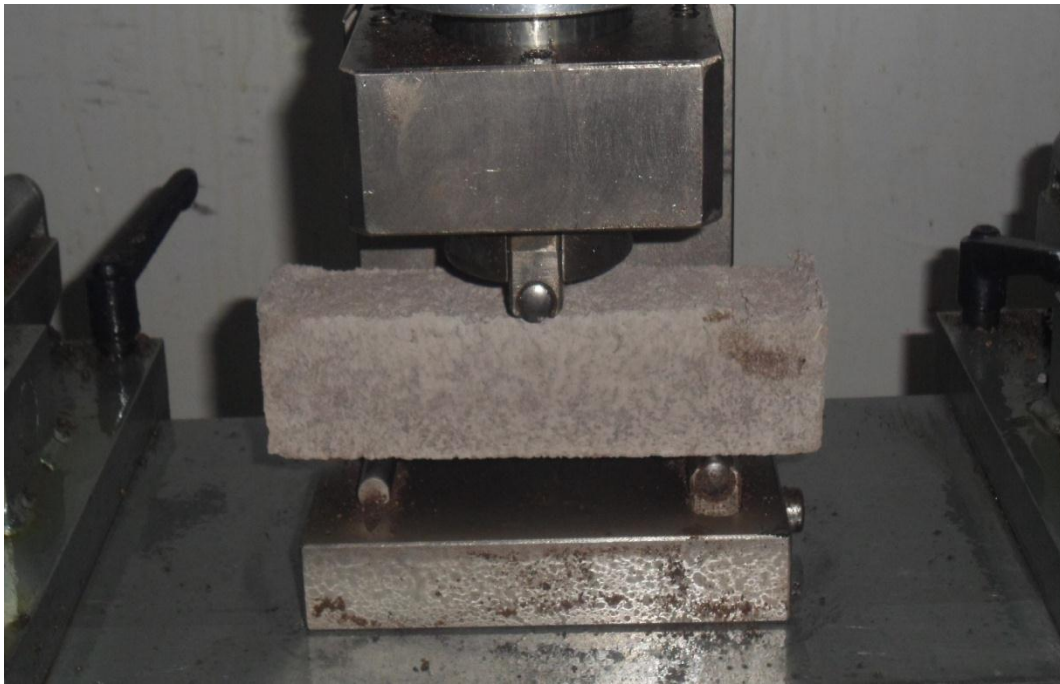
Figure II-3: dispositif pour l'essai de flexion (appareil didactique universelle).
