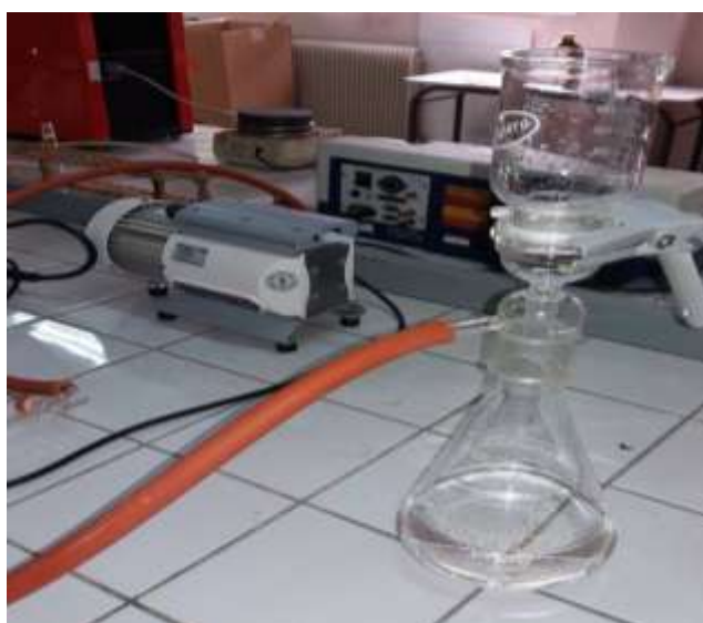
Figure II. 4 : Unité de microfiltration
