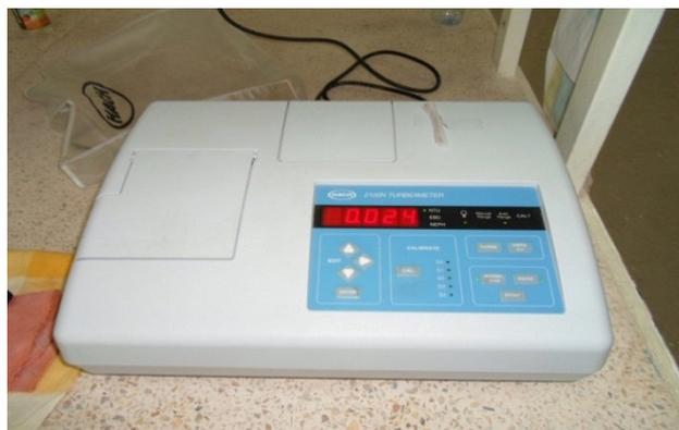
**Figure V.2:** Photo du turbidimètre utilisé
