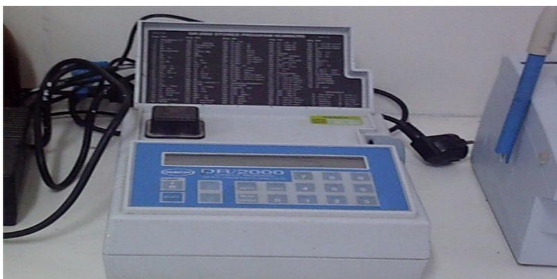
**Figure V.4:** Photo du spectrophotomètre DR/2000 [50]
