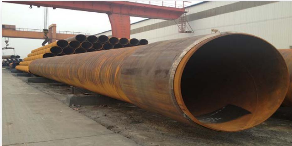
Fig.1.8 Conduite en acier [14]
