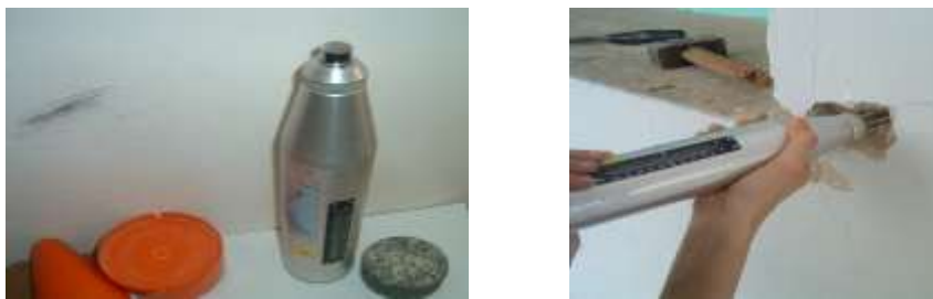
Figure 3.10 : Mesure de la résistance du béton à la compression par le scléromètre.
