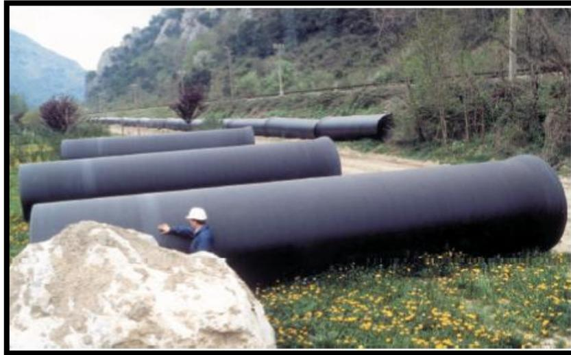
*Figure N°4 : Conduites en fonte ductile*
