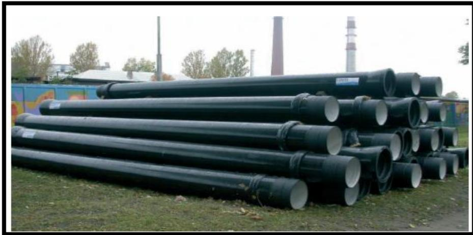
*Figure N° 6: Conduites en fonte ductile revêtue extérieurement en polyéthylène*
