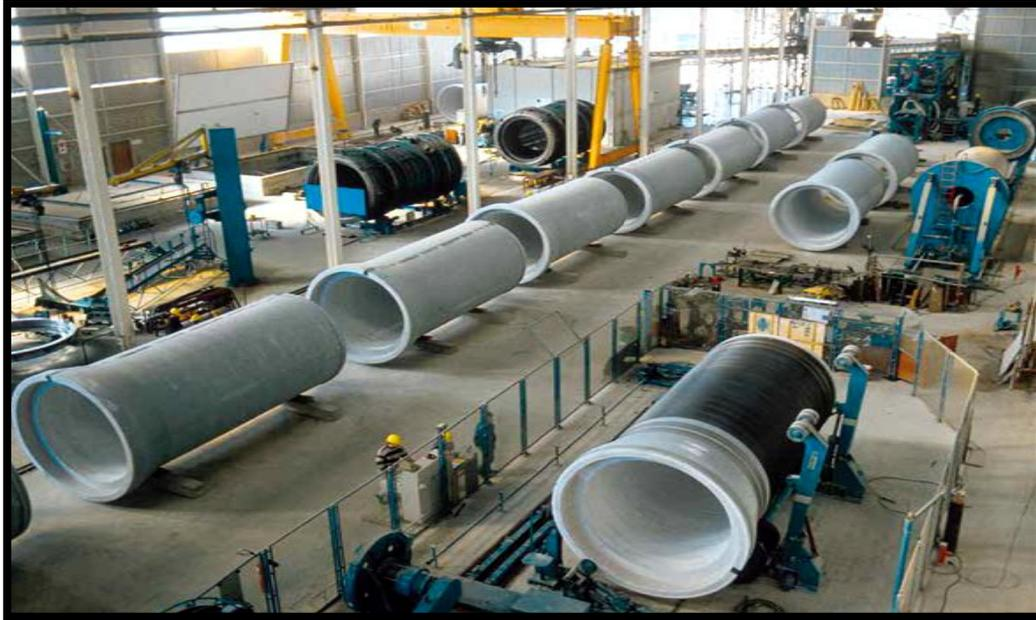
Figure N°18: Conduites en BPAT- fabrication à l'usine
