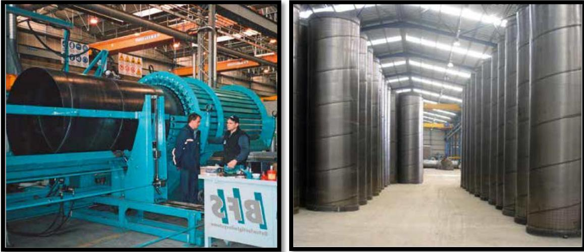
Figure N°19: Ames en tôle déjà testées contre les fuites et prêtes à l'emploi.
