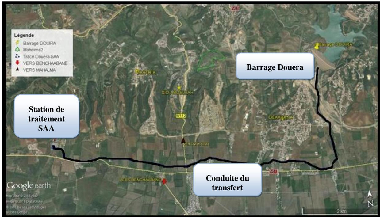
Figure N°43: Tracé du transfert du barrage Douera vers Ouest d'Alger
