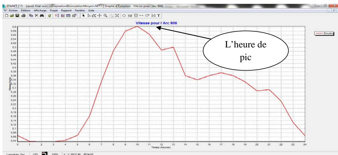
Figure IV.16 : Répartition de la vitesse du tronçon 906 pour le deuxième modèle de consommation au cours de la journée.
