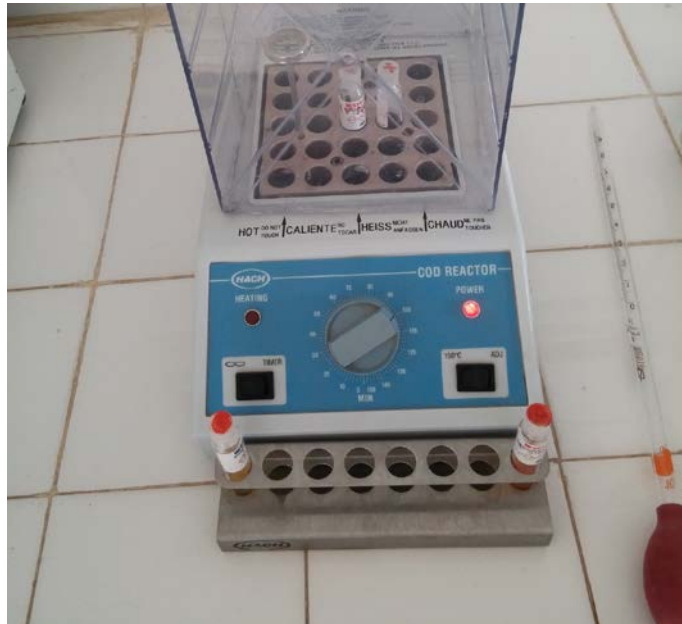
Figure IV. 14: Photo du réacteur d'oxydation de la D.C.O (HACH)
