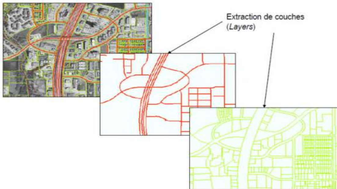
Figure II. 5 : Extraction des couches [23]
