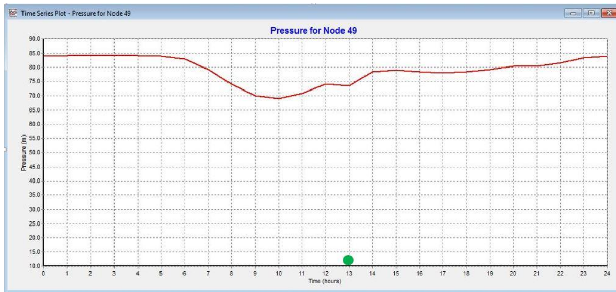
Figure V. 17 : Graphique comparatif entre la pression mesurée et la pression simulée au Point12 (nœud 49)
