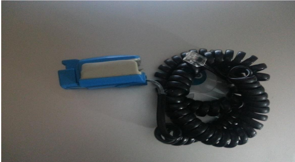
Figure II.9. Capteur Optique réalisé avec entrée RJ11.
