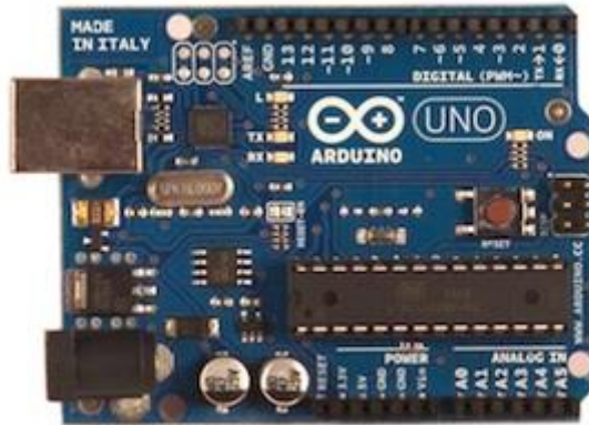
Figure IV.8. La Carte Arduino Uno
