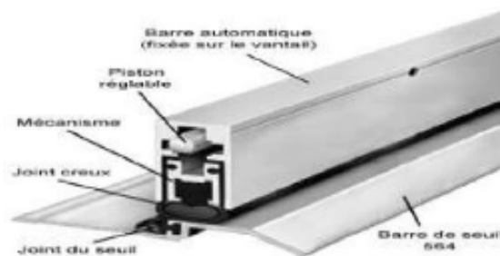
Figure :Exemple de système d'Isolation phonique des portes (Barre automatique dotée d'un système à guillotine réglable)
