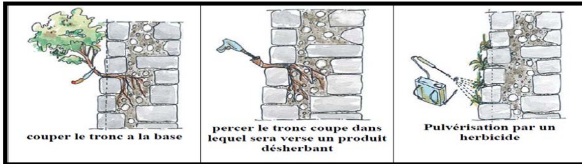
Figure: Elimination de la végétation sur un mur
