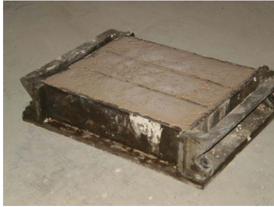
Figure 2. 3 Moule prismatique 7x7x28 (cm)
