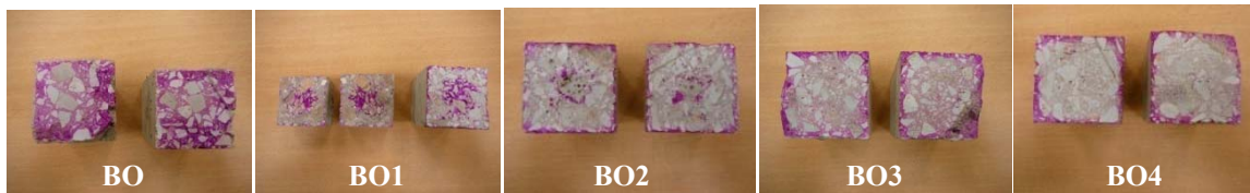
Figure 3. 11 Carbonatation accélérée à 2 jours sur les bétons BO, BO1, BO2, BO3 et BO4.
