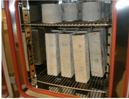
Figure 2. 10 Enceinte climatique assurant l'homogénéisation.
