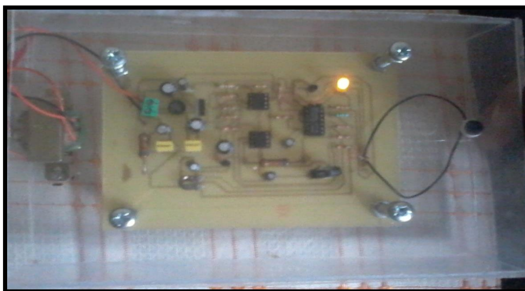
Figure IV.14 : Capteur de bruit réalisé
