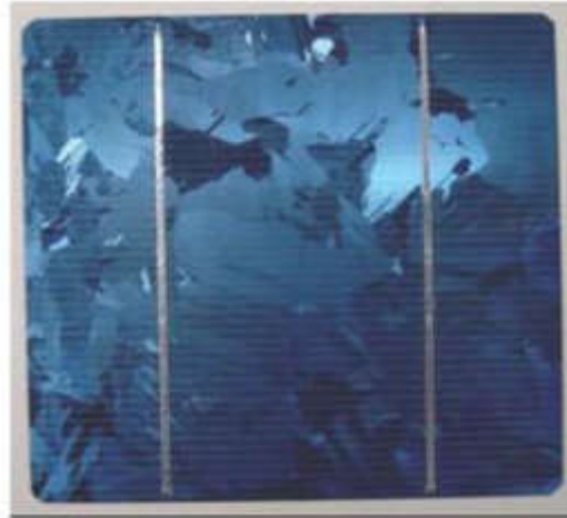
Figure II. 15 : Cellule photovoltaïque à base de silicium polycristallin. [7]
