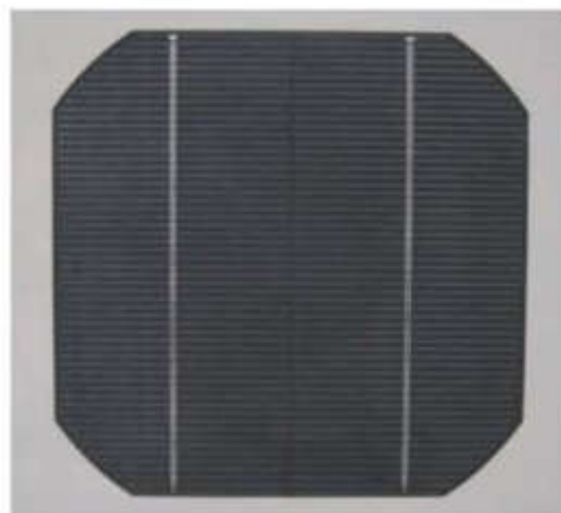
Figure II. 16 : Cellule photovoltaïque à base de silicium monocristallin. [ 7]
