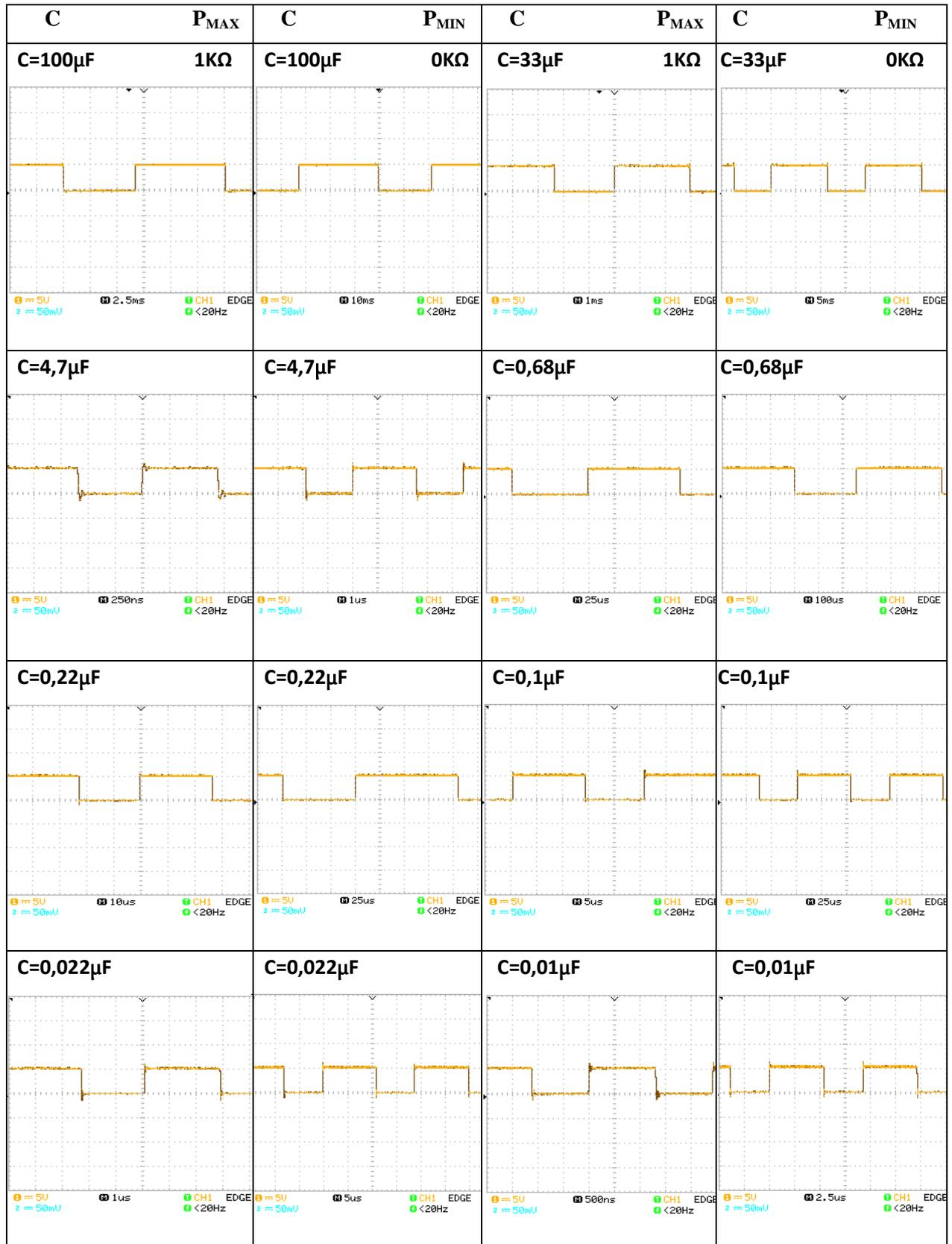
Figure III.6 : Chronogrammes obtenus à la sortie du GBF à base de portes NAND TTL
