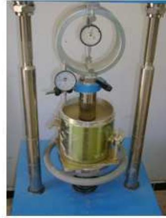
Essai IPI du sédiment de Cheurfas
