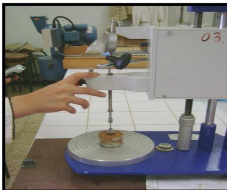
Photo 4.7. Détermination de  $W_L$  par l'essai du pénétromètre à cône
