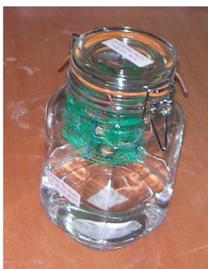
Pose des échantillons dans les bocaux des solutions salines saturées
