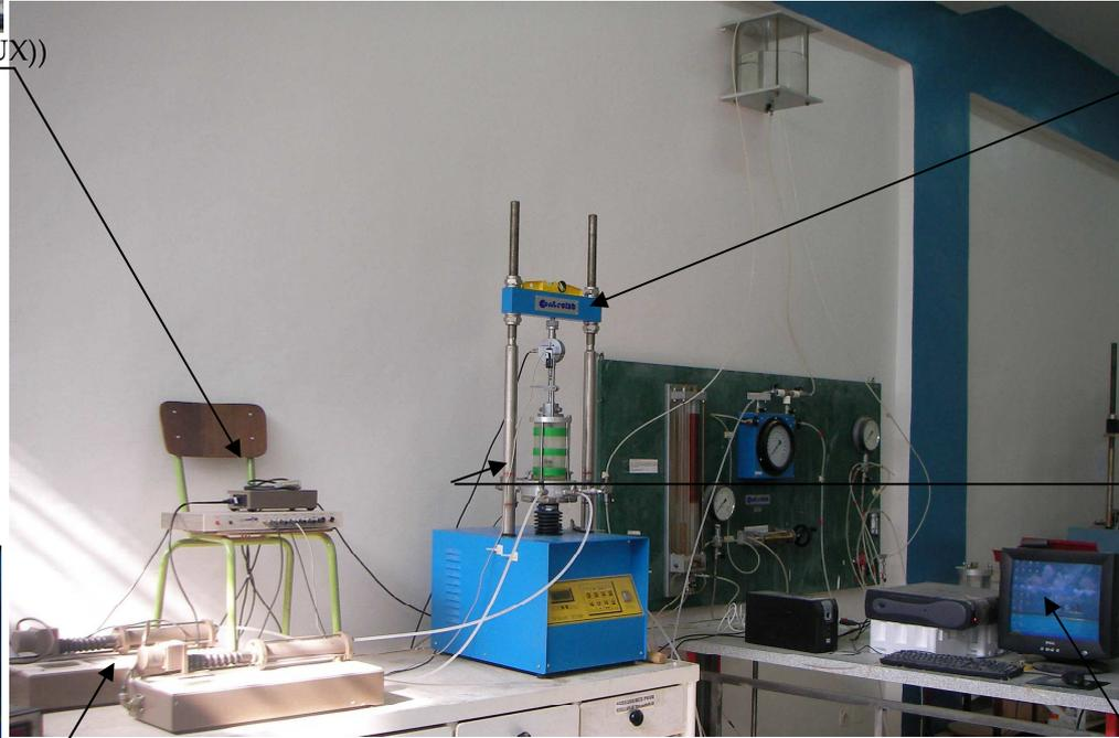
Figure 6.20. Appareil triaxial équipé de tous ces accessoires (Laboratoire EOLE, Faculté de Technologie, U
