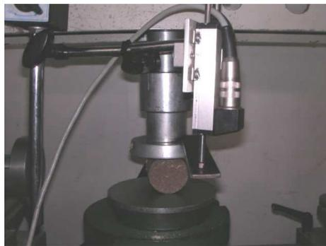
Photo 6.6. Illustration de l'essai de compression diamétrale.
