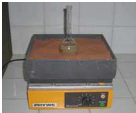
Photo 4.6. Détermination de  $\gamma_s$  par l'essai au pycnomètre
