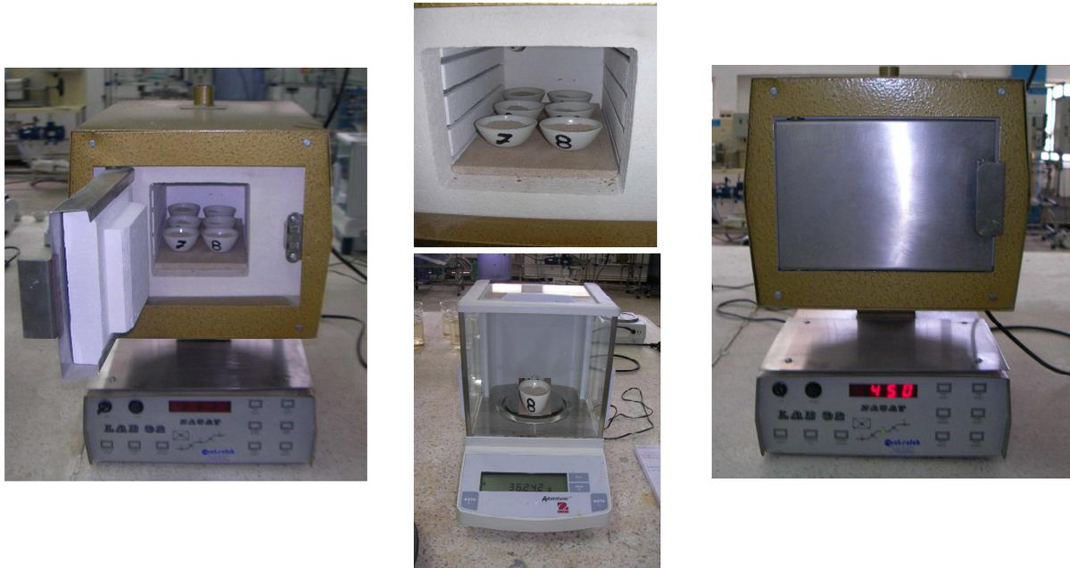
Photo 6.1. Calcination à 450°C des combinaisons de mélanges.
