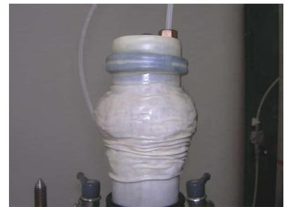
Déformation en forme de tonneau après cisaillement
