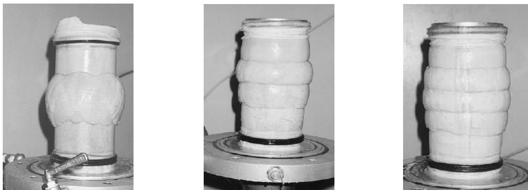
Figure 3.15. Photos d'échantillons cisailés (Haeri et al., 2000)
