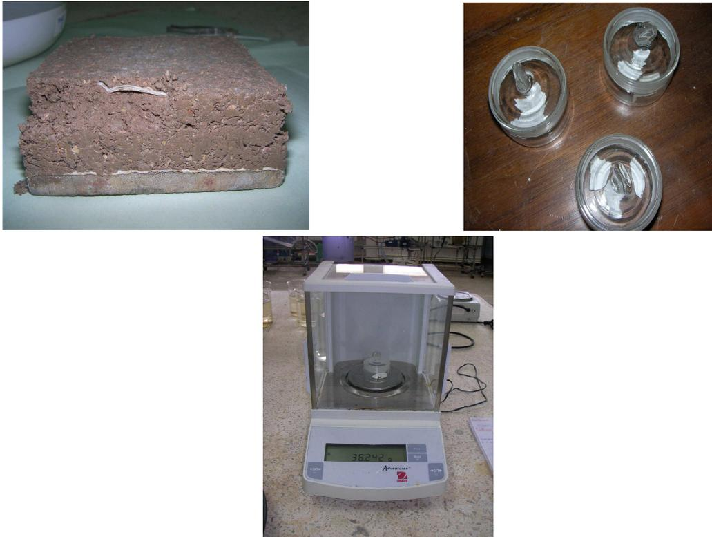
Photo 7.6. Introduction du papier wattman 42 dans les échantillons compactés et mesure de leurs sucions en fin d'essai de cisaillement direct
