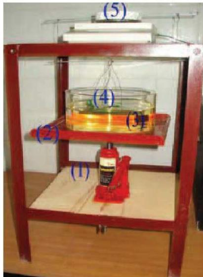
(1) : Dispositif de levage ; (2) : Support ; (3) : Kerdane ; (4) : Echantillon ; (5) : Balance de précision  $10^{-2}$ g
