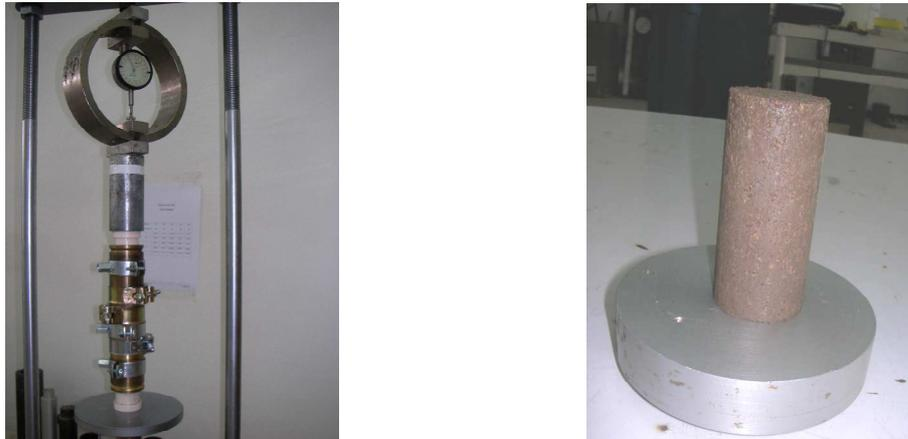
Photo 6.14. Compactage par double compression statique d'une éprouvette de mélange pour un essai triaxial
