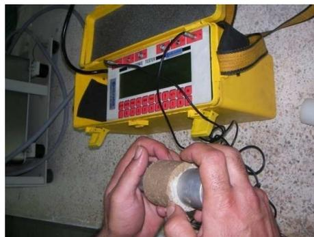
Photo 6.5. Mesure du module d'élasticité E par la méthode d'auscultation dynamique ou ultrason.
