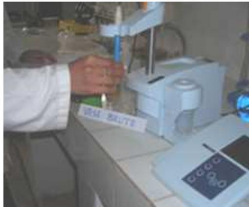
Photo 4.12. Détermination du PH
