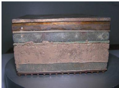
Interface Saturé sol-GEO à  $w_{OPM}$ ,  $\sigma_v = 3\text{bars}$
