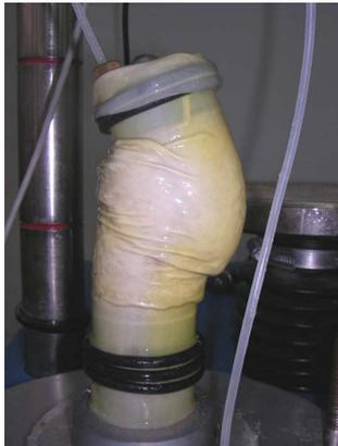
Apparition de plan de rupture après cisaillement
