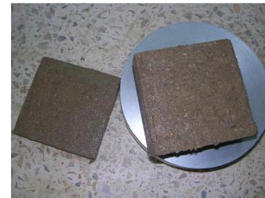
Photo 7.9. Apparition nette de frottement à l'interaction sol-Géotextile Armater après essais de cisaillement direct pour les états saturé et non saturé
