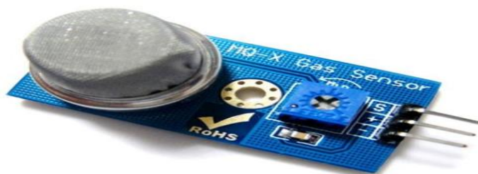
Figure 5.3 capteur gaz combustible MQ-2
