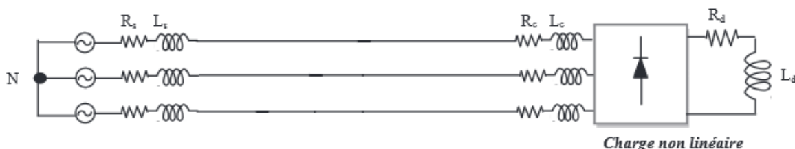
Figure 2.4: Structure simplifiée du réseau électrique
