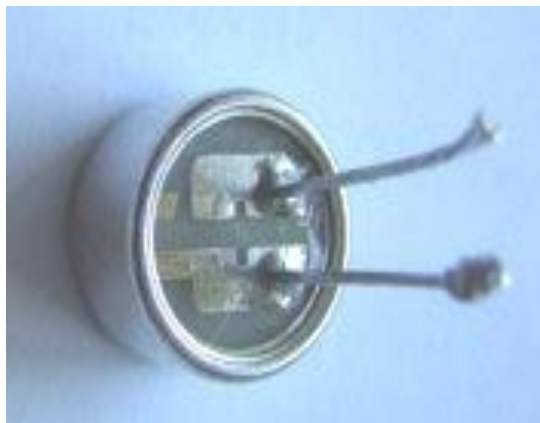
Figure 2.15 : Microphone à électret [9].
