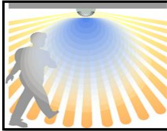
Figure 1.15 : DétECTEURS ultrasoniques (US) [4]
