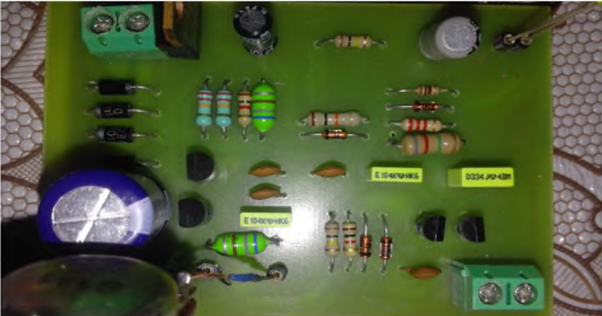
Figure III-11: Photo de la face avant de circuit imprimé après insertion
