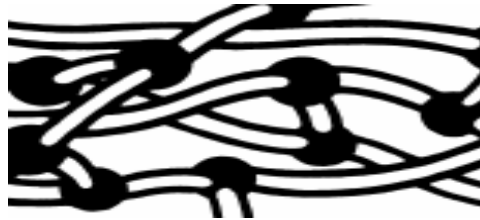
Figure I.1 : Structure d'un thermodurcissable [5].
