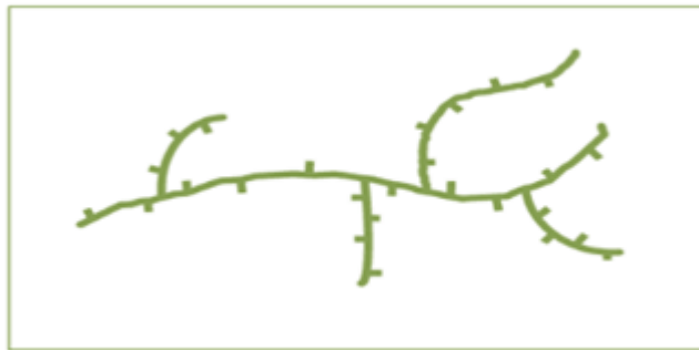
Figure II.1: Structure de polyéthylène basse densité (PEBD) [25].
