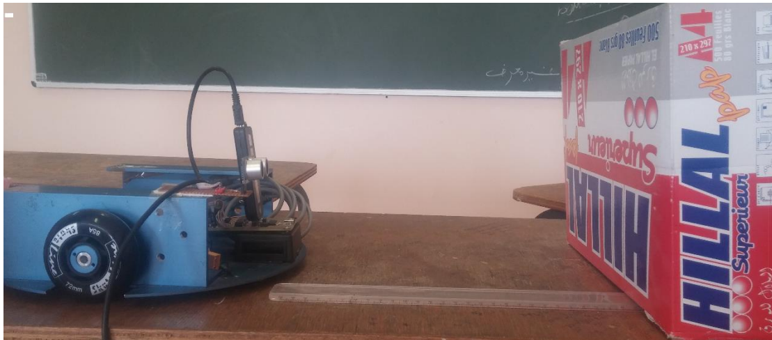
Figure 4.8:essai expérimental de Capteur US
