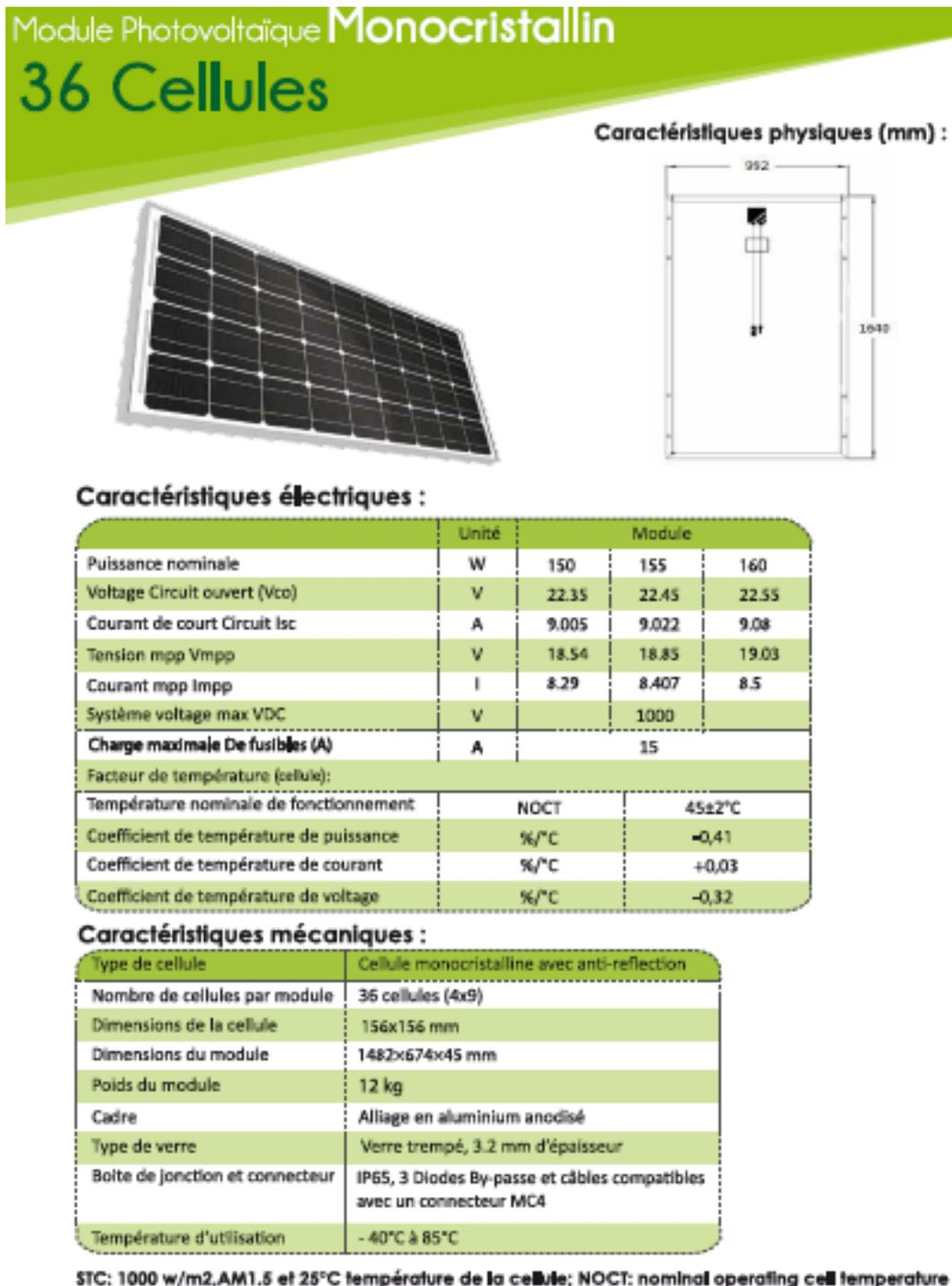
FIGURE B.1 – Caractéristiques des modules choisis pour le pompage
