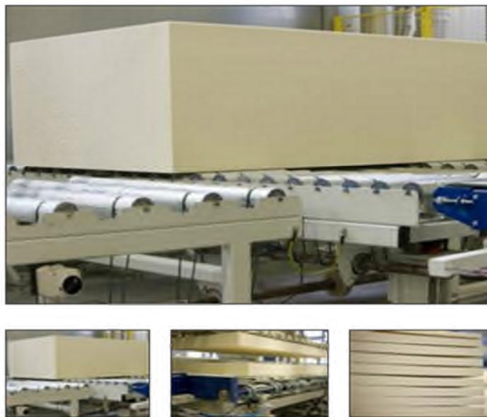
Figure 2.10: Découpe de la mousse.
