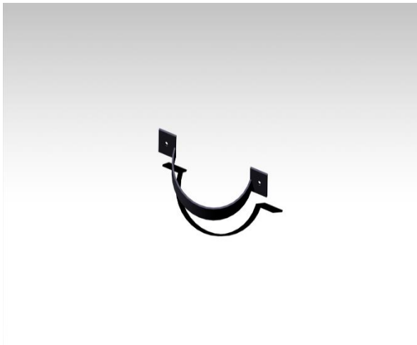
Figure 2.34 : conception de pièce de fixation de Kinect
