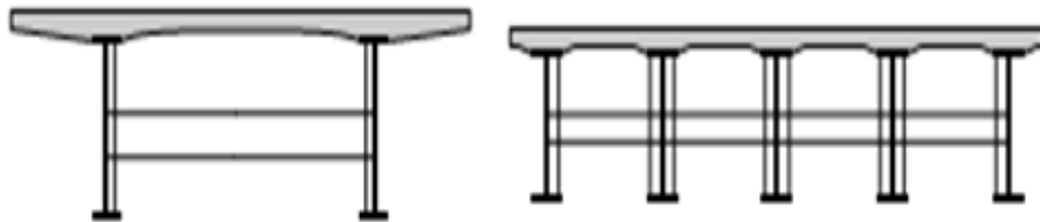
Figure 1-4 : Tabliers à bipoutre et multi poutre
