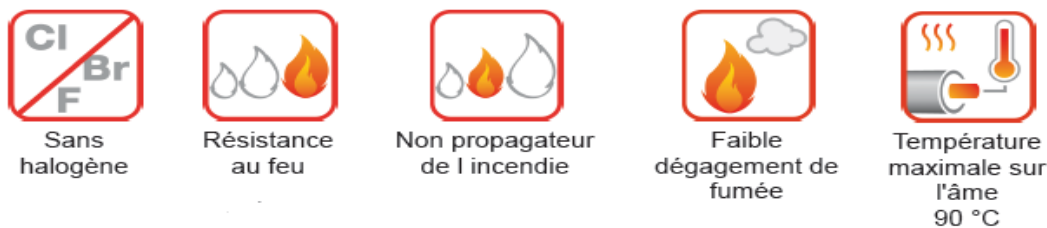
Figure III.23. Caractéristiques des câbles électriques
