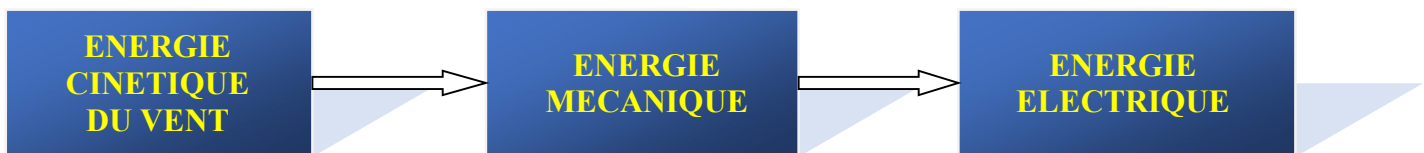
Figure I.1 : Conversion de l'énergie cinétique du vent
