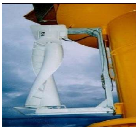
Figure. I.6 : éoliennes à axe vertical de type Savonius [15]
