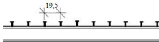
Figure VI.7 : espacement entre connecteurs
