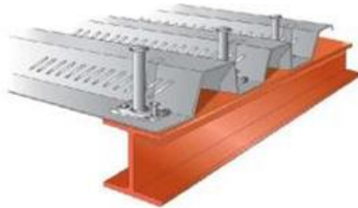
Figure VI.5 : disposition des connecteurs
