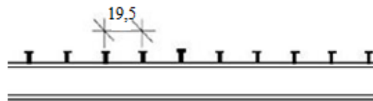
Figure VI.8 : espacement entre connecteurs
