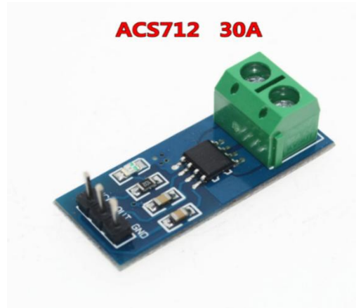
Figure 5. Capteur de courant ACS712
