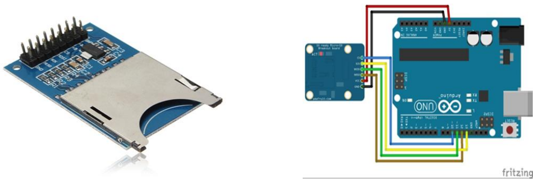
Figure 11. Shield SD et son branchement avec la carte Arduino
