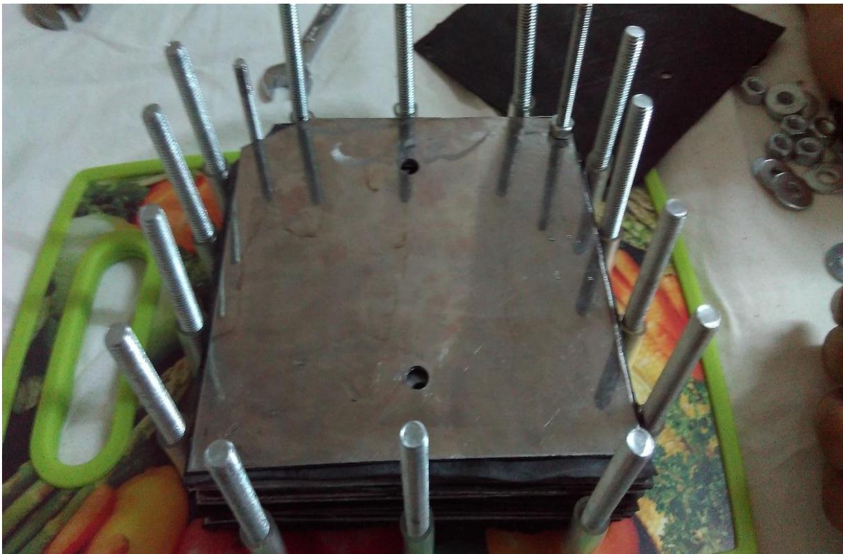
**FigureIII.20** : On ajoute la dernière plaque inox qui joue le rôle de 2<sup>ème</sup> anode et on va fixer le dernier avec un écrou pour passer le courant
