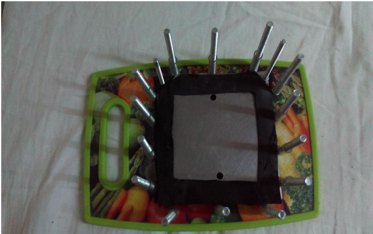
**FigureIII.18** : plaques inox et les joints de caoutchouc.
