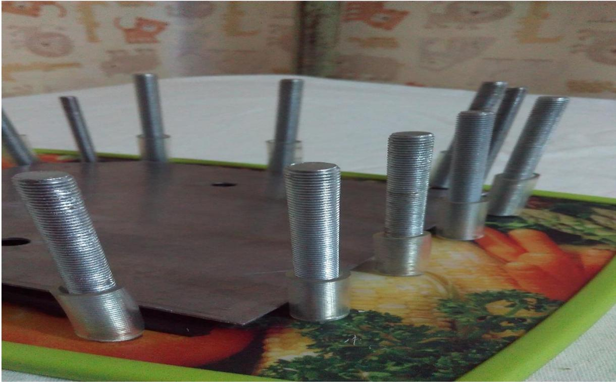
**FigureIII.17** : vis + les pièces de tube
