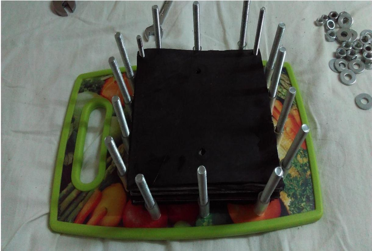
**FigureIII.21** : On ajout les dernier join de couatchouc
