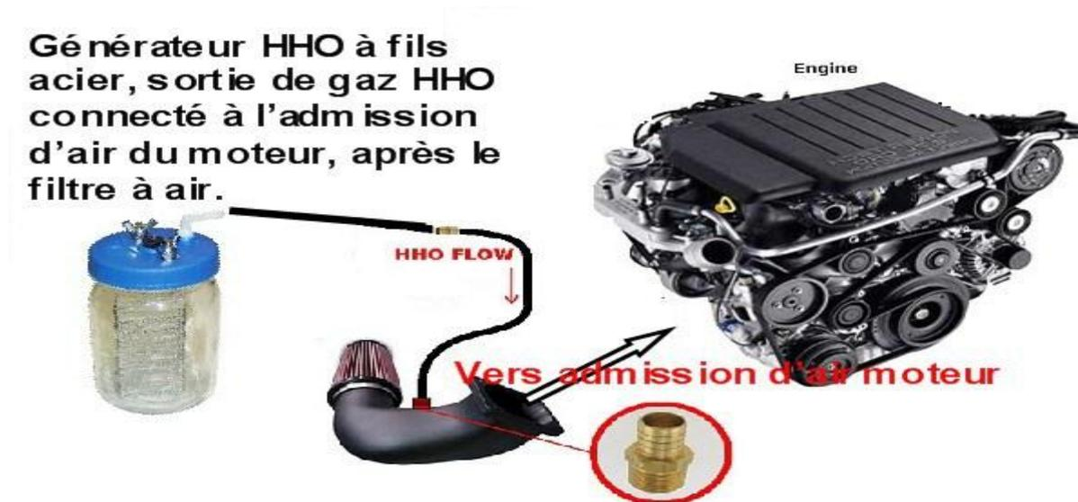
**Figure III.34 :** Application à un moteur de voiture
