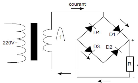
Figure II.4 : Circuit du redressement double alternance.
