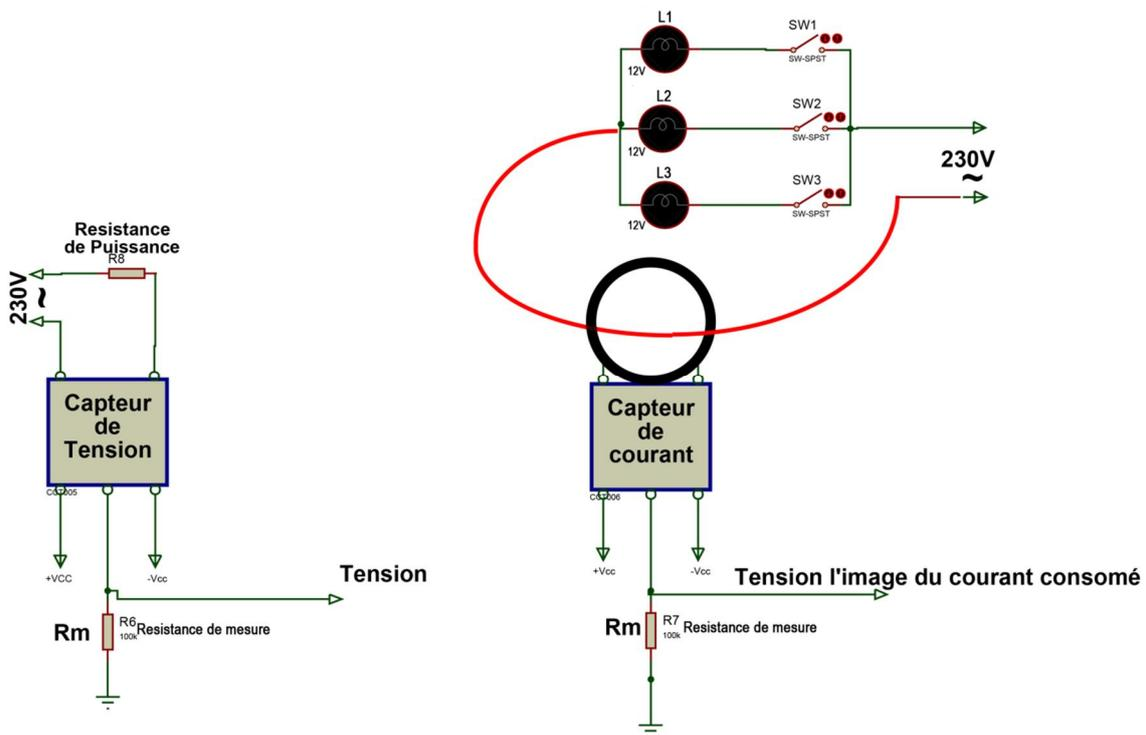
Figure II.11 : Circuit de mesure réalisé sous Isis.
