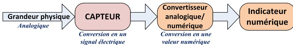
**Figure II.7 :** Schéma bloc d'un système de mesure numérique.
