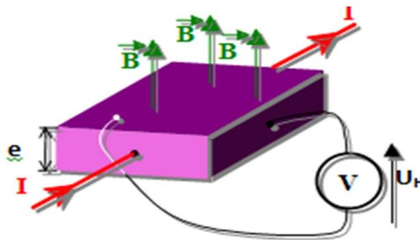
Figure II.8 : schéma significatif du l'effet Hall
