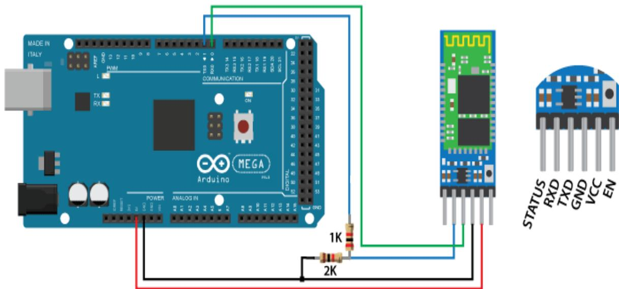
**Figure II.19** : Branchement du module HC05 avec Arduino.
