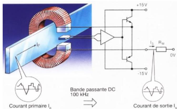
**Figure II.9** : principe d'un capteur à boucle fermée.
