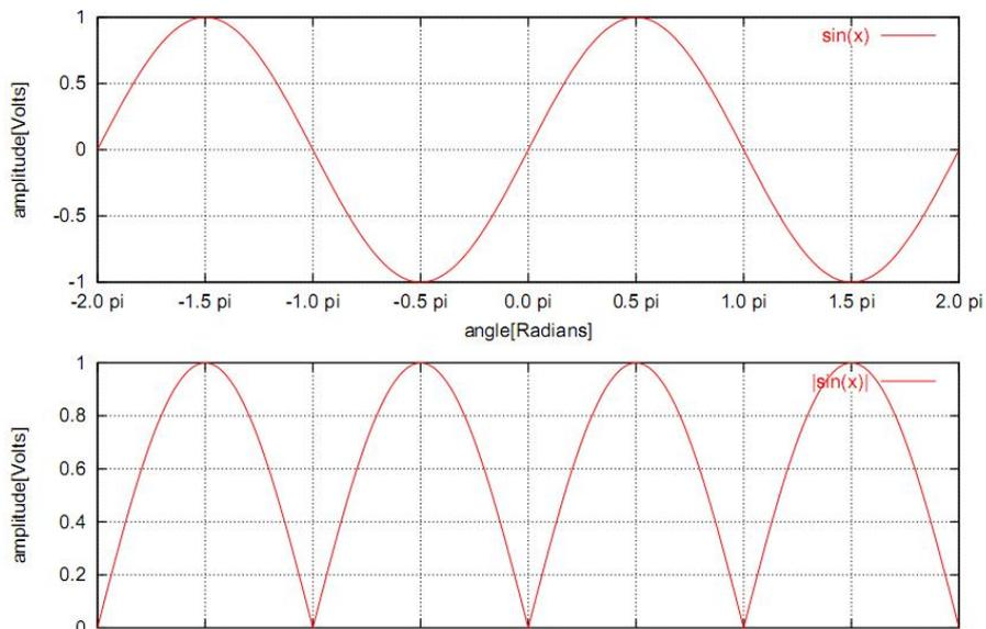
Figure II.5 : Courbes du redressement double alternance.
