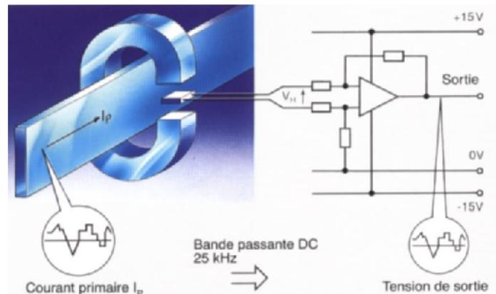
**Figure II.10 :** principe d'un capteur à boucle ouverte.
