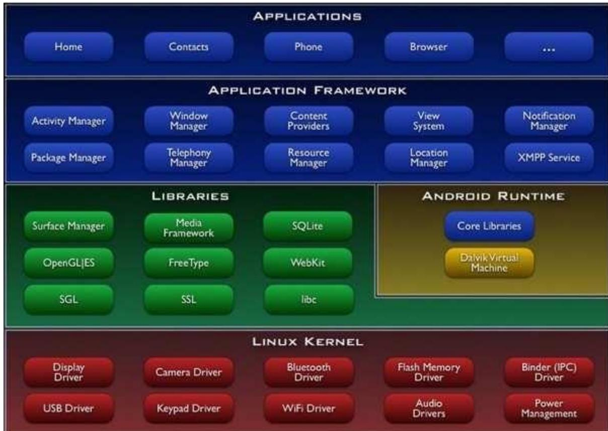
Figure III.2 : L'architecture de la plateforme Android [20].
