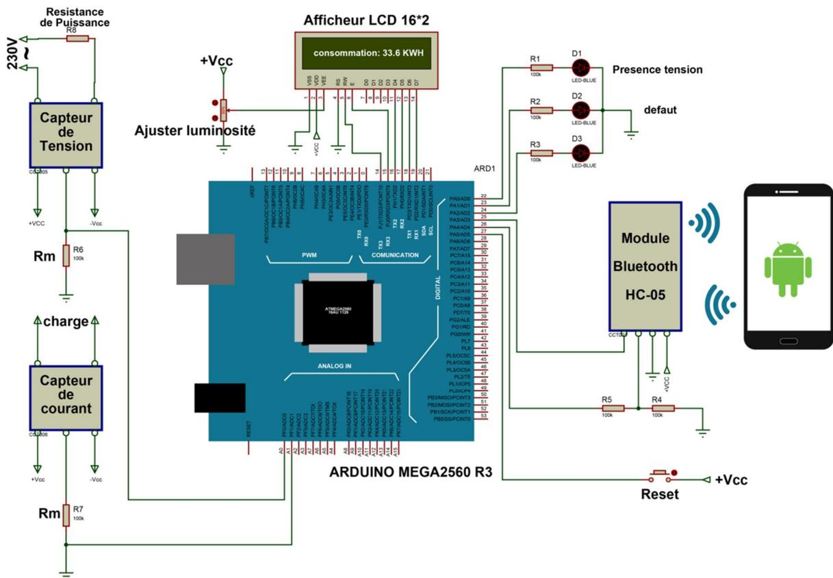
**Figure II.21 :** Le circuit de la carte électronique réalisé sous ISIS-ORTEUS.
