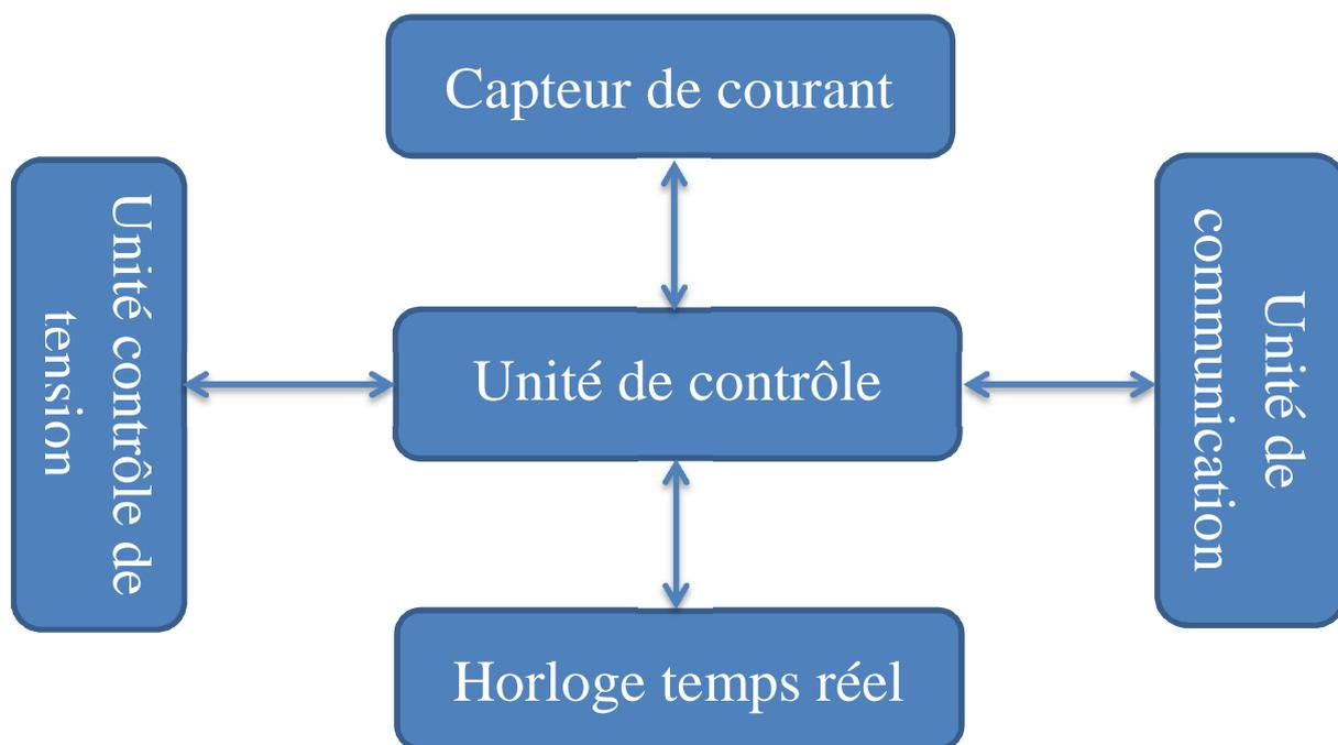
Figure I.1: Architecture d'un compteur intelligent.
