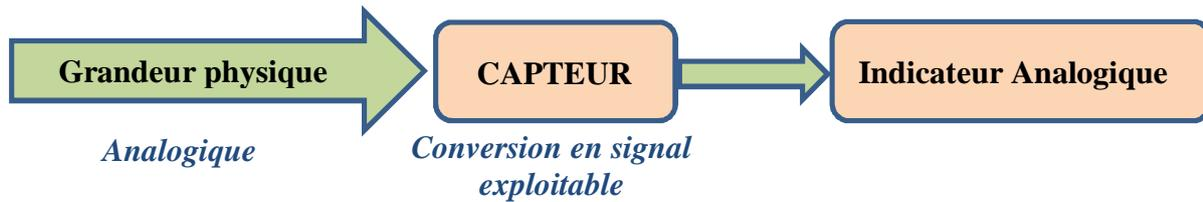
**Figure II.6 :** Schéma bloc d'un système de mesure analogique
