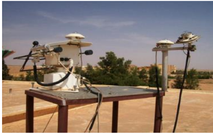
Figure I.5 : Appareils de mesure du rayonnement solaire [20]
