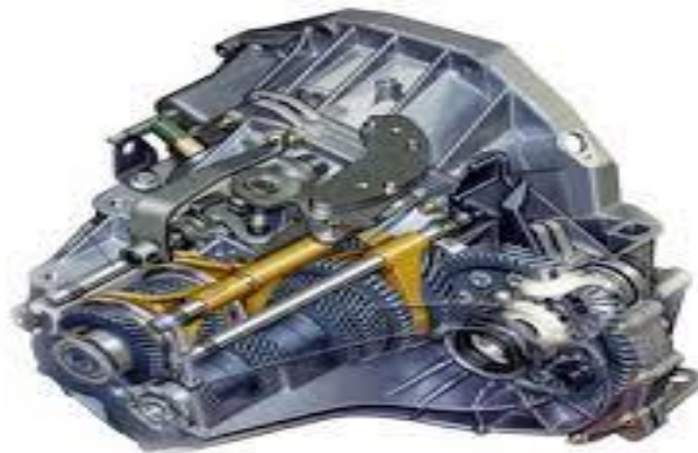
Figure I.1 Représentation d'une boîte à vitesse [3].
