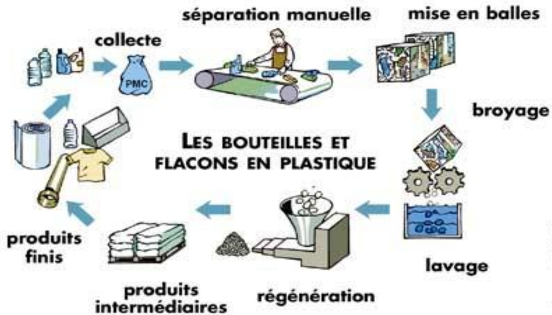
Figure 2.12 SCHEMA GENERAL DU PROCESSUS DE RECYCLAGE DU PLASTIQUE [10]
