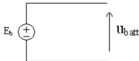
Figure III.5 : Modèle idéal batterie
