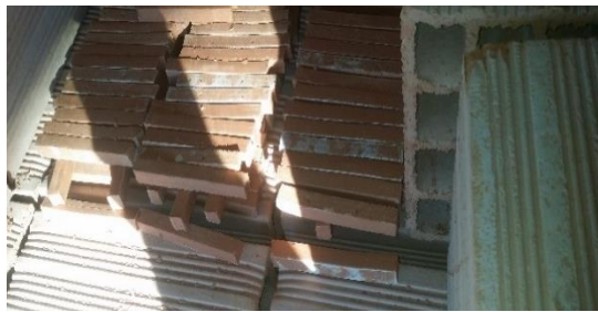
Figure 38 : illustration du posage des éprouvettes dans le four.
