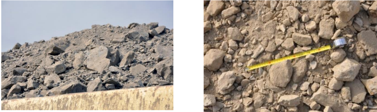
Figure 5 : illustration de changement de granulométrie d'argile après concassage.
