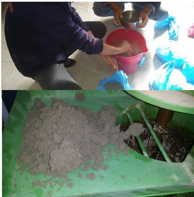
Figure 33 : illustration de malaxage manuel et le versement dans la mouleuse.
