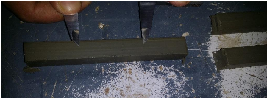
Figure 35 : illustration du marquage pour le calcul de retrait.
