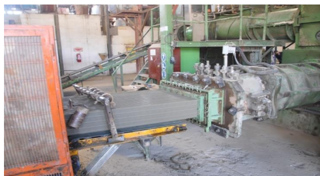
Figure 8 : illustration de la sortie de la mouleuse et l'entrée au coupeur.
