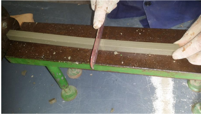
Figure 34: illustration de la coupe de boudin sorti de la mouleuse.
