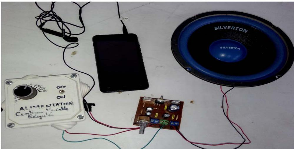
**Figure III.8 : Réalisation et test pratique de notre mini-amplificateur audio de puissance utilisant le circuit intégré TDA2030.**
