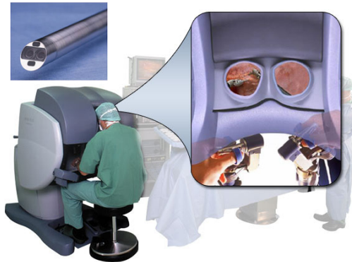
FIGURE 1.5 – Robot Da Vinci avec système de vision stéréoscopique.
