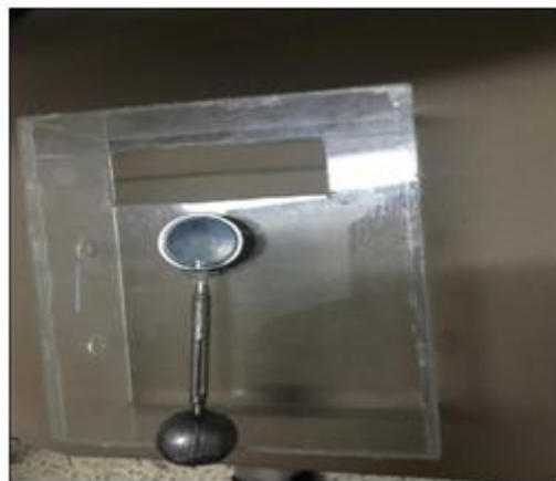
Figure IV.9 Fixation de la masse dans le boîtier
