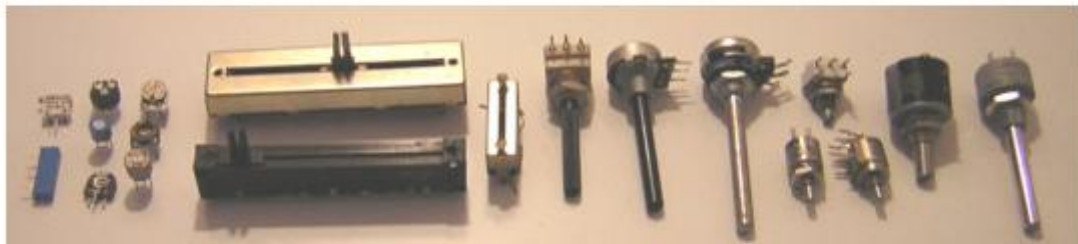
Figure I.6 Différentes type des potentiomètres résistif
