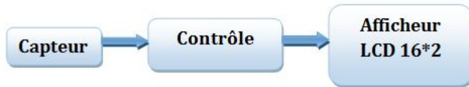
Figure III.4 Structure d'une chaîne d'acquisition
