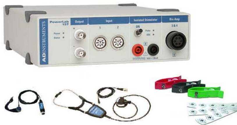
FIGURE 5.1: Système d'acquisition PowerLab avec les différents capteurs employés dans la détection des signaux physiologiques.
