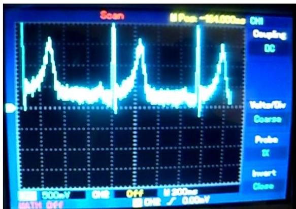
Sur l'oscillogramme, nous pouvons remarquer que le signal est effectivement amplifié jusqu'au niveau + 2,2V voulu mais qu'il y a toujours un bruit, due aux parasites notamment électro myographique mauvais contact des électrodes etc., c'est pour cela que nous allons maintenant effectuer un second filtrage afin de supprimer ce bruit.
