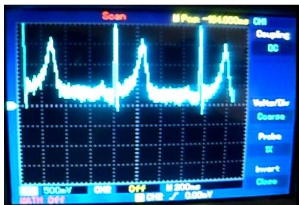
Lors de récupération de la sortie de ce étage à l'oscilloscope nous remarquons qu'il y a toujours une raie très importante sur le 50Hz, dûe au secteur d'alimentation, c'est pour cela que nous allons maintenant effectuer un troisième filtrage afin de la supprimer.
