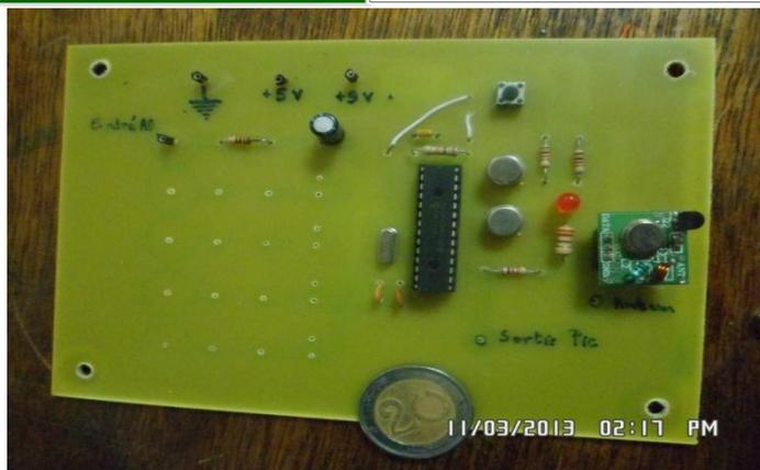
Figure V-19 : Circuit numérisation et d'émission HF
