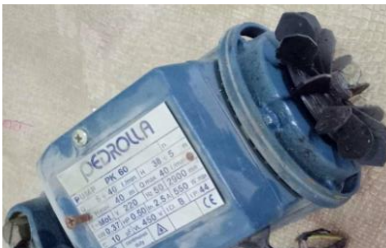
Figure 19 : moteur de pompe avant modification
