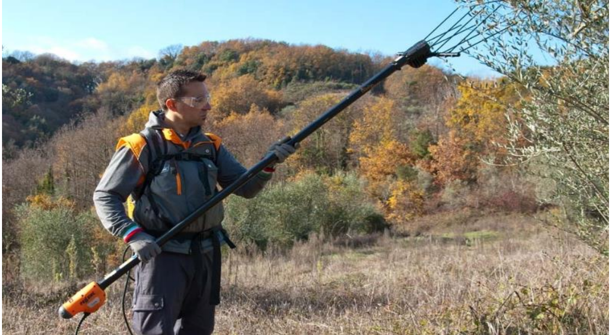
Figure 13 : Vibreur de branches avec source d'énergie reliée au dos de l'opérateur
