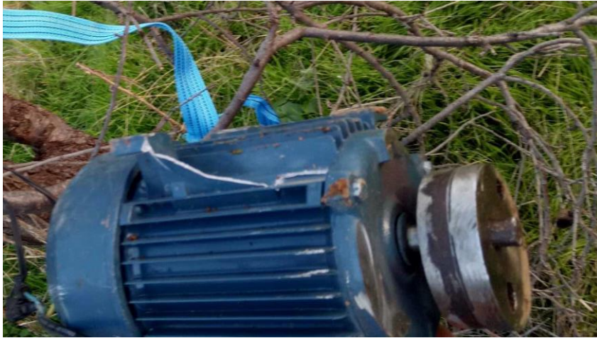
Figure 20 : Moteur de pompe après modification
