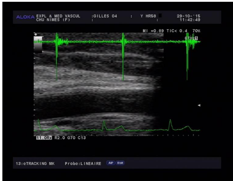
Figure 39. Imagerie en mode B de l'artère brachiale enregistrée avec la carte Picolo. En haut les bruits de Korotkoff et en bas le signal ECG.
